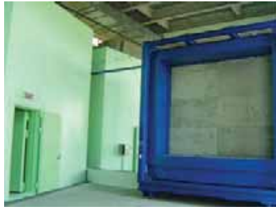
(a) 牆板隔音測試設施
