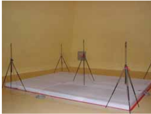
圖 7-22 吸音性能量測實驗室
