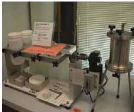
圖 3-3 TCLP 毒性溶出檢測設備
