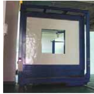
(b) 窗戶隔音測試設施
