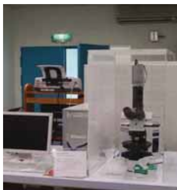
圖 3-2 偏光顯微鏡-石棉檢測設備
